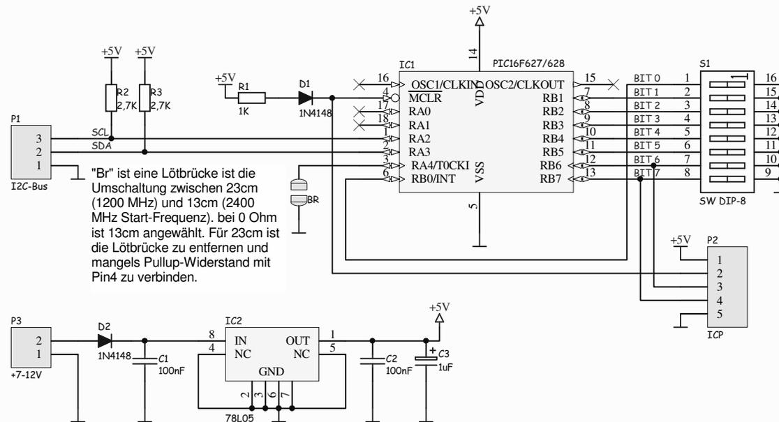
"Br" ist eine Lötbrücke ist die Umschaltung zwischen 23cm (1200 MHz) und 13cm (2400 MHz Start-Frequenz). bei 0 Ohm ist 13cm angewählt. Für 23cm ist die Lötbrücke zu entfernen und mangels Pullup-Widerstand mit Pin4 zu verbinden.
